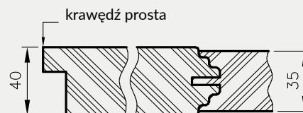
Przekrój poziomy drzwi Scala, Berge
